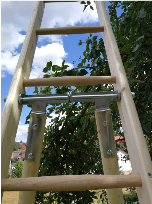
Befestigung der Pfahlstützen
